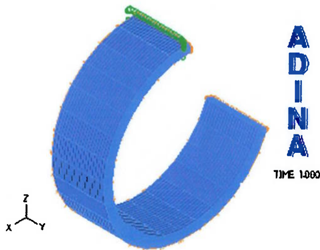
Figura 18: Malha do manômetro construída no ADINA
