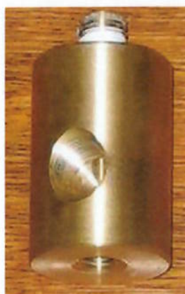
Figura 23: Válvula T dimensionada pela equipe para conexão dos dispositivos
