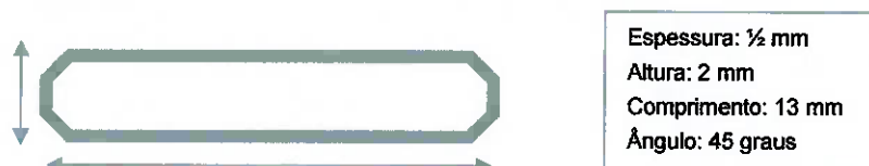
Figura 16: Seção transversal do manômetro
