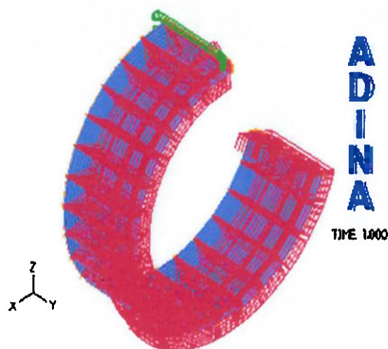
Figura 19: Carregamento utilizado em simulação no ADINA
