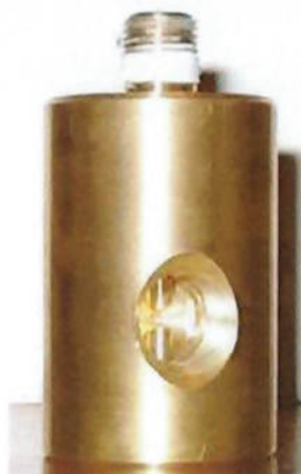
Figura 23: Válvula T dimensionada pela equipe para conexão dos dispositivos
