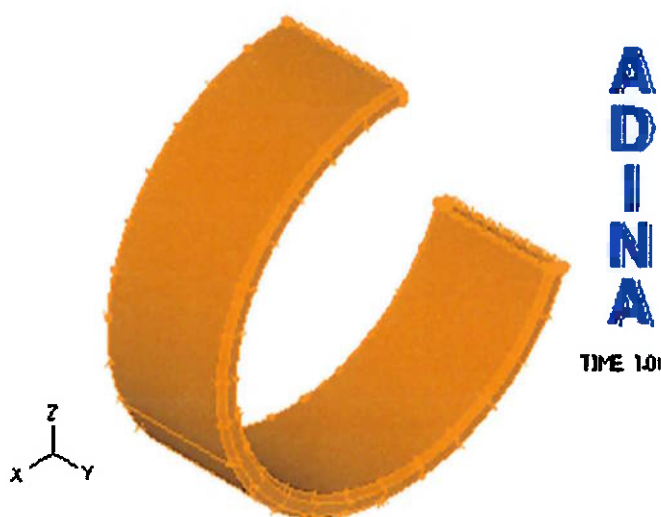
Figura 17: Geometria do manômetro construída no ADINA
